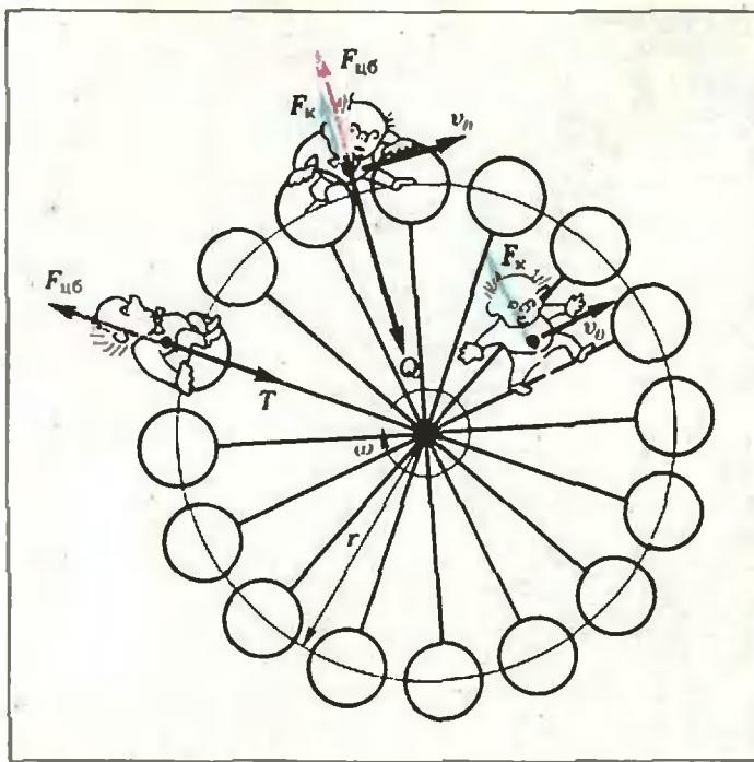
Рис. 3. Силы инерции во вращающейся системе отсчета.
