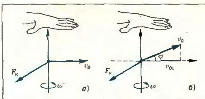
Рис. 5. Правильное направление силы Кориолиса определяется с помощью правила левой руки.
