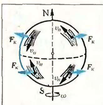
Рис. 7. Сила Кориолиса прижимает воду к правому берегу в северном полушарии и к левому — в южном.
